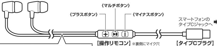
イヤフォンコードの2対密着している部分は、優しく裂く事で分離の長さを調節することができます。※一度引き裂いたコードは再密着できませんのでご注意ください。
