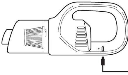
本体側面にある充電ソケットに付属の充電用USBケーブルを差し込み、パソコンなどのUSBポートへ接続すると充電が始まります。充電中は確認ランプが赤色点灯し、充電が完了すると青色点滅になります。
