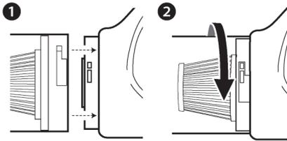
ダストカップを本体の溝に合わせ、矢印の方向にカチッと音が出るまで回してしっかりと固定します。
