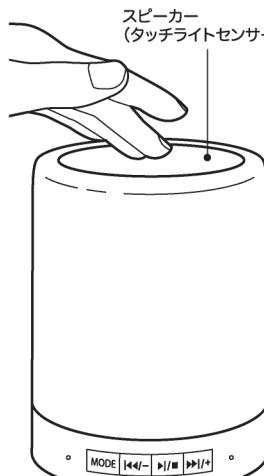
本体上部のスピーカー(タッチライトセンサー)にタッチする毎にライトが切り替え点灯します。
