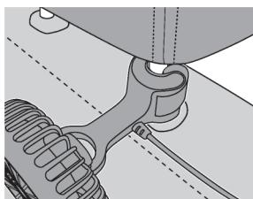
②シャフトにしっかりと取付けができる確認します。その後、扇風機を好きな角度に調節してください。
