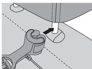
①取付け部分をヘッドレストのシャフトに押し当て、ぐっと押し込みます。
