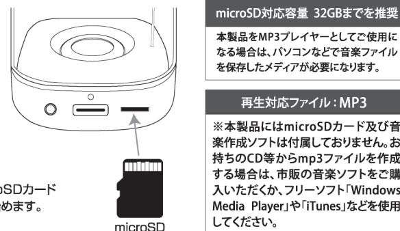
※microSDカードは端子面が表になるようにカチッと音がするまで差込みます。※microSDカードを押すと、取り出することができます。
