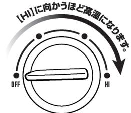
電源ダイヤル(温度調整ダイヤル)
