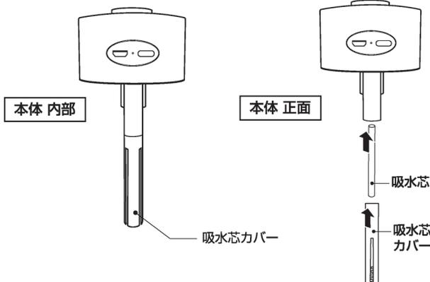
上部ユニット内部の吸水芯カバーを引っ張って外してください。次に吸水芯を引っ張って外してください。交換用の吸水芯を入れて、吸水芯カバーをセットしてください。上部ユニットをタンクにセットしてください。
